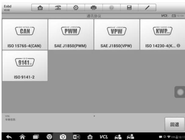
图 4-13 “OBD II 诊断菜单” 示图
