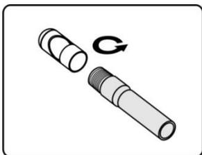
2. 将配件的螺纹部分拧进成像头以固定配件。
